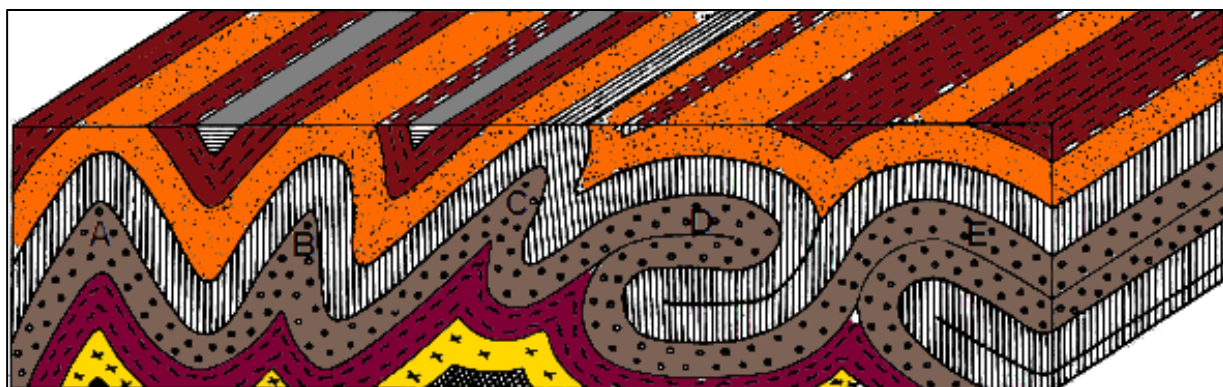
Sl. 35. Tipovi bora u odnosu prema osnoj plohi: uspravne (A), kose (B), prebačene (C), polegle (D) i utonule bore (E) (Izvor: Brazda i dr., 1992).
