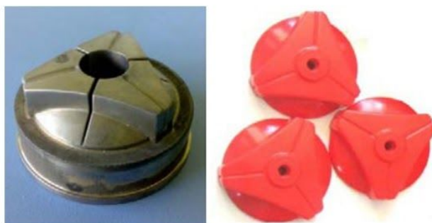
Lijevani dijelovi ubrizgavani pomoću alata SLS
