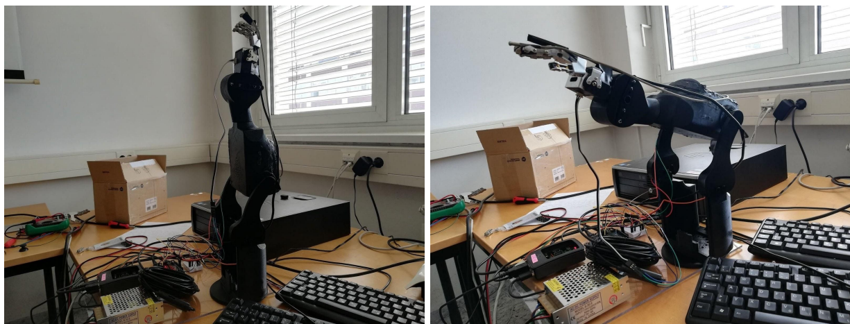
Primjer robotske ruke s 3D ispisom.
